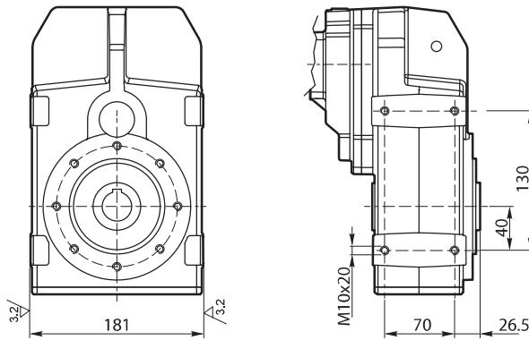
Flange uscita/ Output flange / Abtriebsflansch
