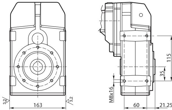
Flange uscita / Output flange / Abtriebsflansch
