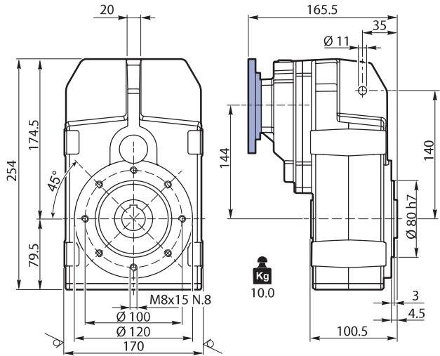
Albero uscita / Output shaft / Abtriebswelle
