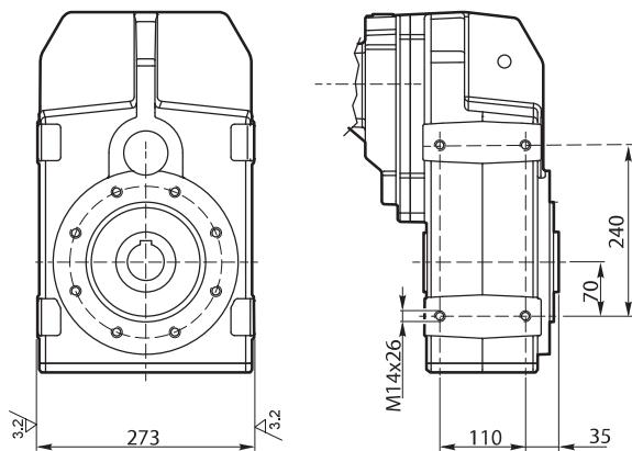
Flange uscita / Output flange / Abtriebsflansch
