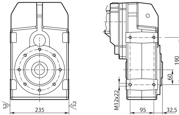
Flange uscita / Output flange / Abtriebsflansch
