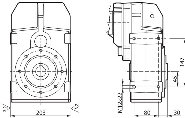
Flange uscita / Output flange / Abtriebsflansch
