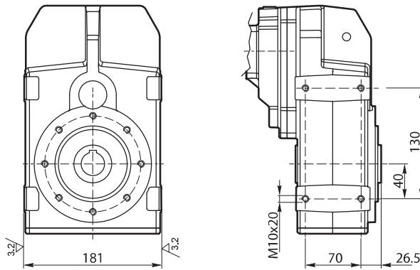
Flange uscita / Output flange / Abtriebsflansch
